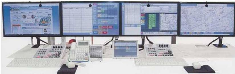
119番通報の受付から災害地点の決定、出動車両の編成、出動指令までの一連の事案処理を行う指令管制の主装置部です。システムを構成する各装置と連携し、迅速で的確な災害現場活動を支援します。輻輳時には1席の指令台で2事案の対応が可能です。
