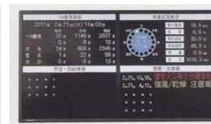
署所に設置された46インチ液晶モニタに消防・救急に必要な気象情報や指令情報等を表示します。
