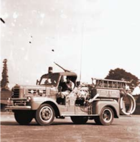
開署時配置された水槽付消防ポンプ自動車
