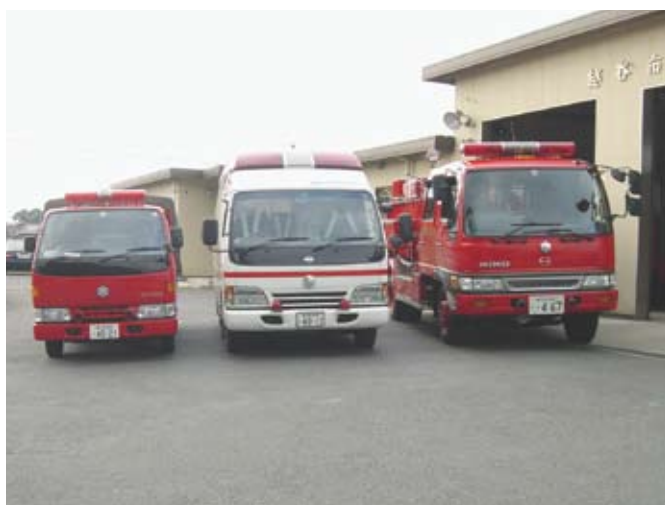
大袋分署の配置車両（左から資機材搬送車、高規格救急車、水槽付消防ポンプ車）
