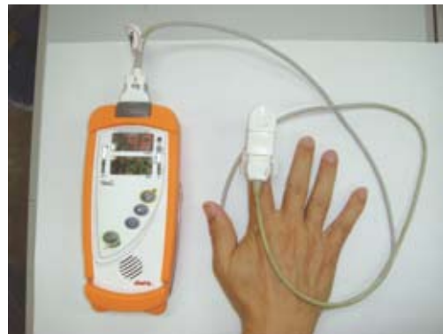
血中酸素飽和度測定器 動脈血酸素飽和度を測定する器具です。
