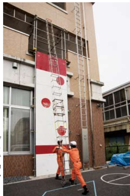
三連はしご (チタン製掛金安全装置付) 架てい可能な高さ (最大8.7m) の調整、器具重量 (31kg) の軽量化、操作手順が容易であることから消火活動や救助活動等に幅広く活用されています。
