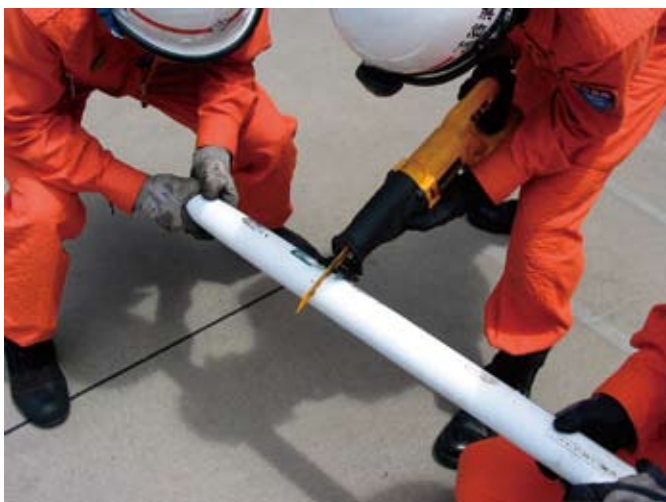
充電式切断機 (ブレードカッター) バッテリーモーターにより安全に鉄材、ステンレス鋼、軽合金、その他の非金属及びプラスチック、木材などを切る携帯用ノコギリです。
