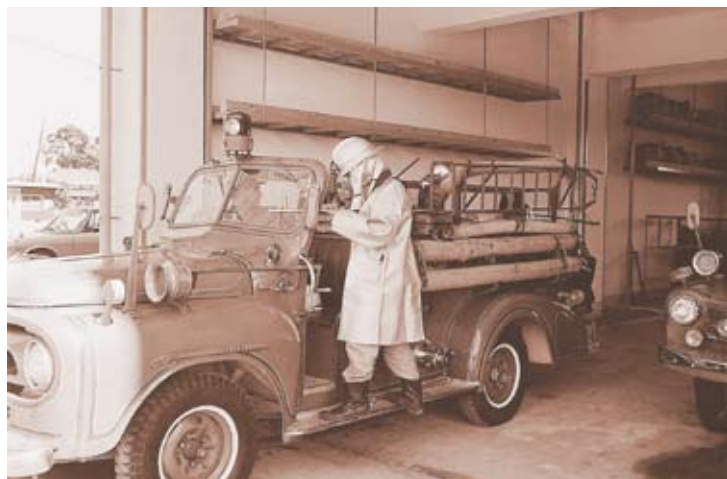
手回しサイレン付消防ポンプ自動車
