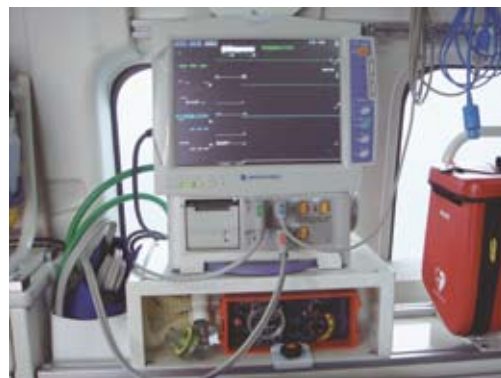
ベッドサイドモニター 血圧や心電図等を測定するために用います。
