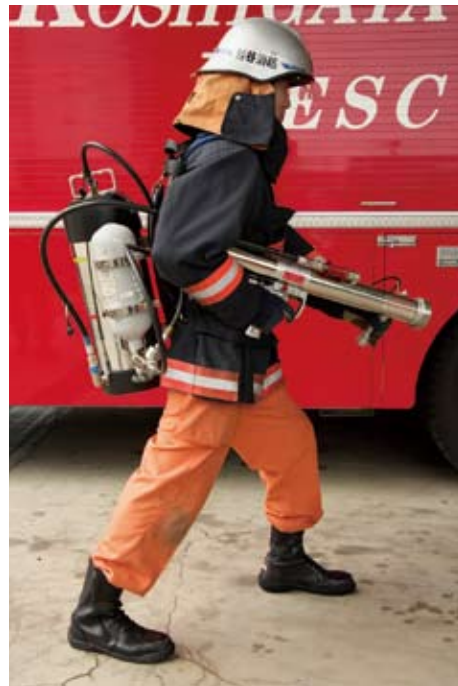
インパルス消火銃 空気ボンベと消火剤容器 (容量約12リットル) が一体となった個人携行型の消火装備です。
