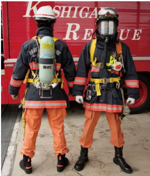
空気呼吸器 (29.4MPa 5リットルボンベ) 煙、有毒有害ガス、酸素欠乏空気等から消防隊員を保護するために、消防活動に欠かすことのできない重要な器具です。
