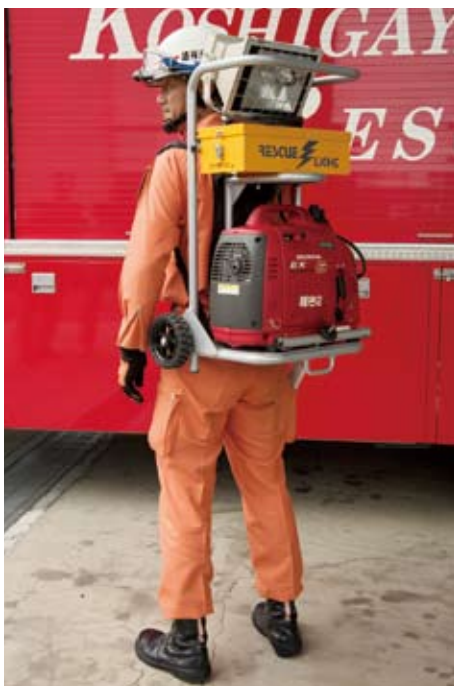
発電機付投光機 (背負い式) 夜間の災害時に、照明用として必要な器具一式がセットになっていて、背負って搬送可能な資機材です。
