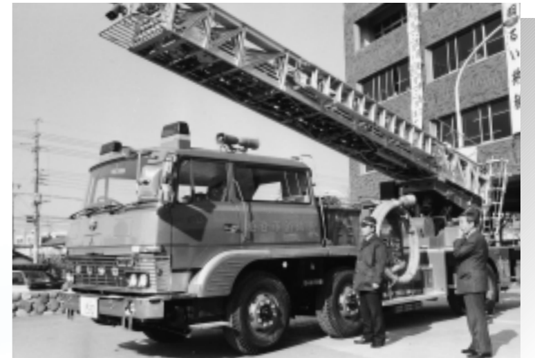
マンションなどの高層化に対処するため配備された35級はしご車
