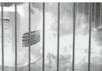
スプレー缶をファンヒーターの前に置いたところ、熱で膨張して破裂し、噴射剤の可燃性ガスに引火したものと写真提供 NITE
