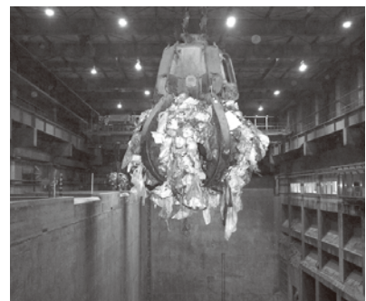
焼却炉にごみを投入する巨大クレーン
