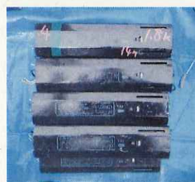
コンデンサーを内蔵する安定器の例
