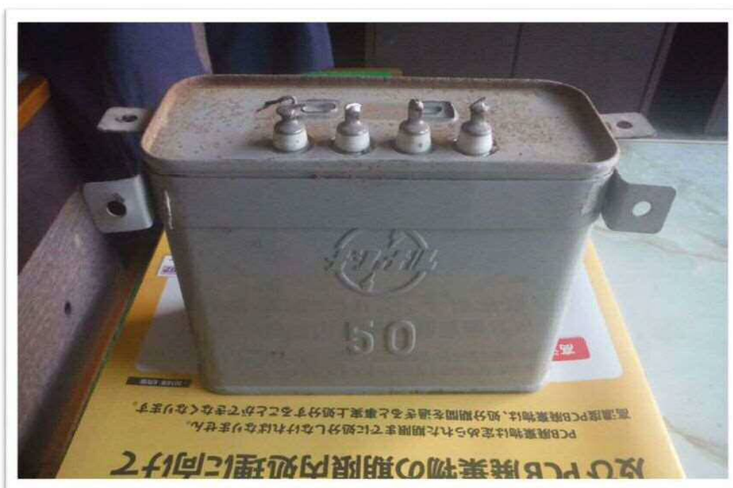
PCB 廃棄物（コンデンサ）調査
