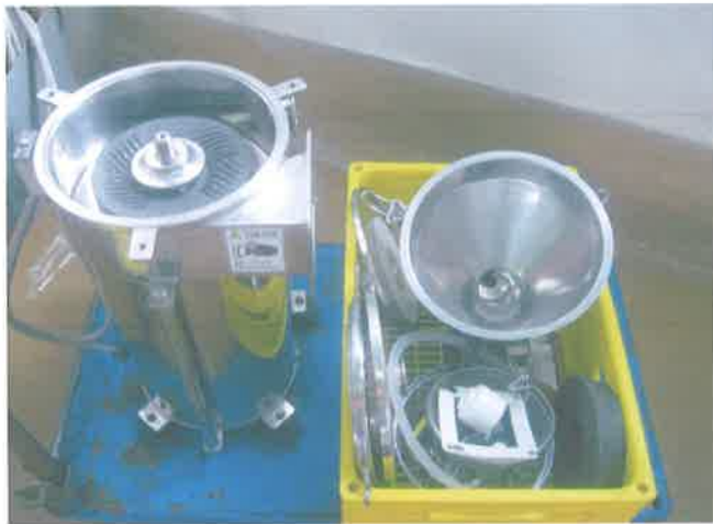
マスコロイダー（石臼摩破機） 醪を細かく滑らかにする
