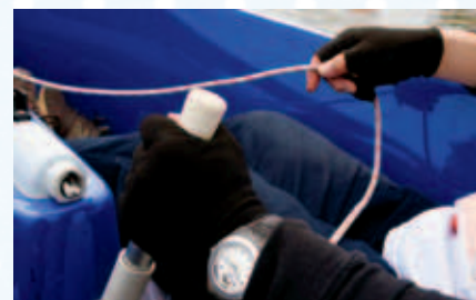
ハンザディンギーを操作する様子 写真のように、進行方向を変えるレバーと帆に繋がっている紐を操作してボートを動かします。
