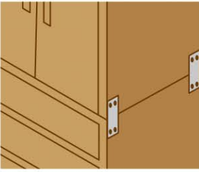
二段重ねの家具は、連結固定器具で上下を連結し、一体化させましょう。
