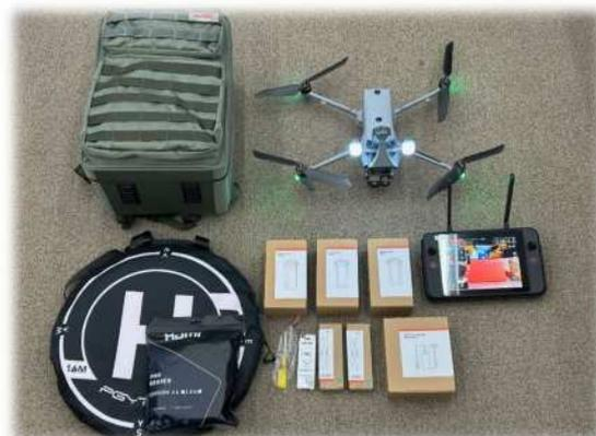
サーマルカメラ（熱画像）と音声発生用のスピーカーを搭載した2機目のドローン。令和6年度に運用開始。
