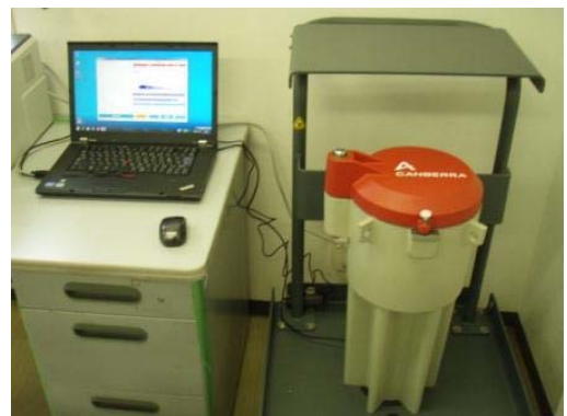
食品放射能測定システム
