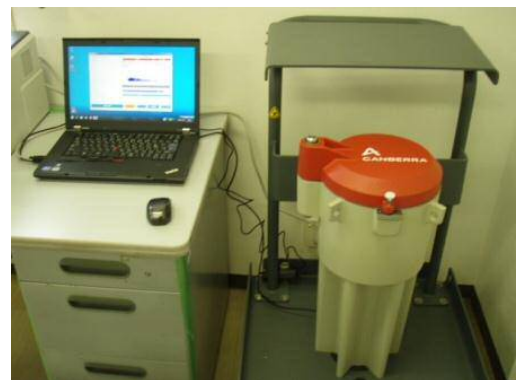
食品放射能測定システム
