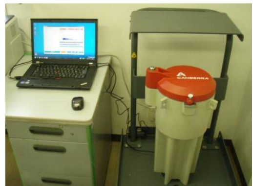
食品放射能測定システム
