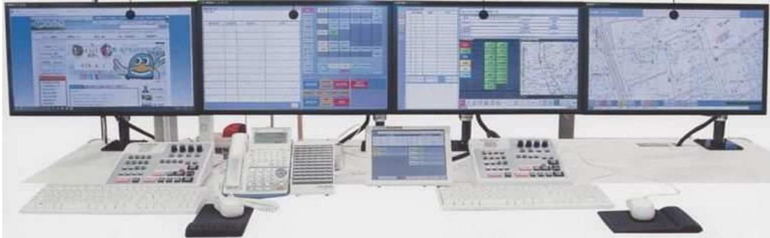
119番通報の受信から災害地点の特定、出動車両の編成、出動指令までの一連の事案処理を行う指令管制の主装置部です。システムを構成する各装置と連携し、迅速で的確な災害現場活動を支援します。輻輳時には1席の指令台で2事案の対応が可能です。
