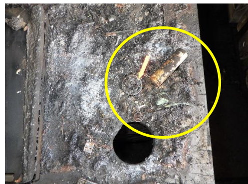
写真8 携帯型扇風機の焼損状況
