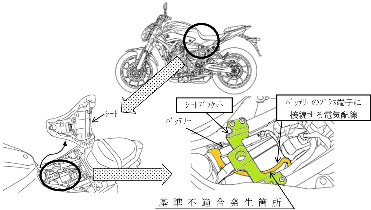
バッテリーのプラス端子に接続する電気配線の長さ及びシートブラケットの形状が不適切なため、電気配線がシートブラケットの上に乗り上げ、シートとシートブラケットの間に挟まることがある。そのため、そのままの状態で使用を続けると、当該電気配線の被覆が損傷し短絡して、最悪の場合、火災に至るおそれがある。
