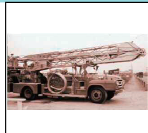
屈折はしご付消防ポン プ自動車《昭和46年2月》
