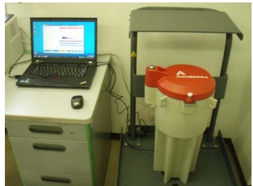
食品放射能測定システム
