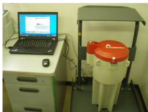
食品放射能測定システム
