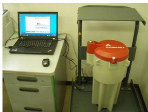
食品放射能測定システム
