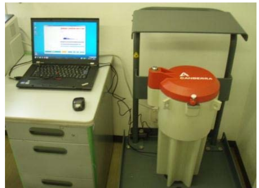
食品放射能測定システム
