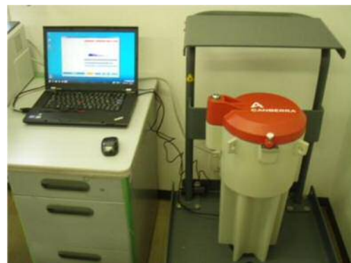
食品放射能測定システム
