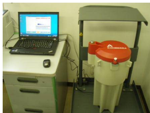
食品放射能測定システム
