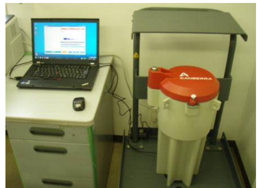
食品放射能測定システム
