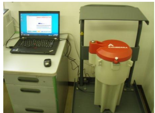
食品放射能測定システム
