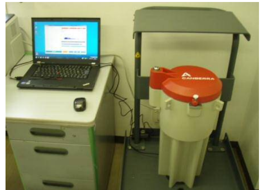
食品放射能測定システム
