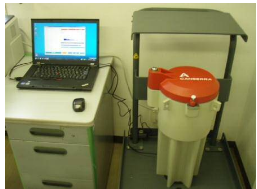
食品放射能測定システム
