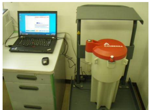
食品放射能測定システム
