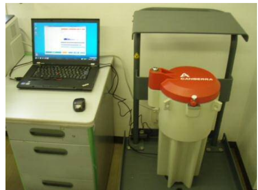
食品放射能測定システム
