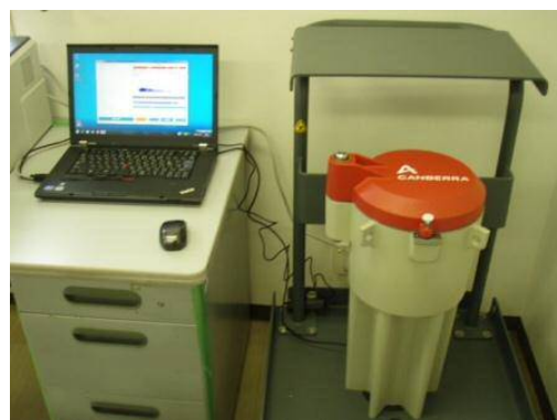
食品放射能測定システム
