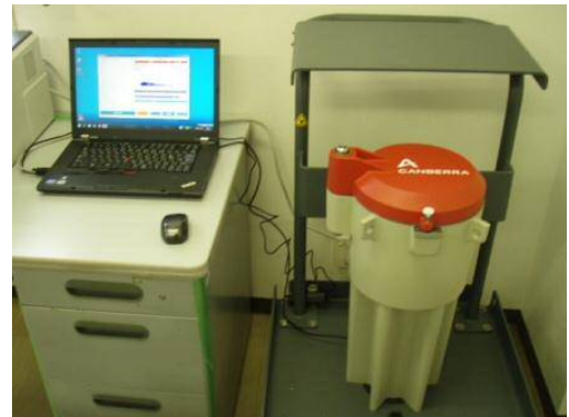
食品放射能測定システム
