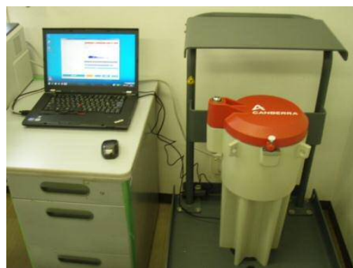
食品放射能測定システム
