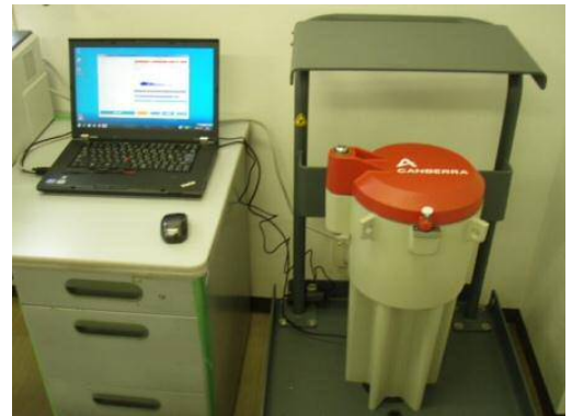
食品放射能測定システム
