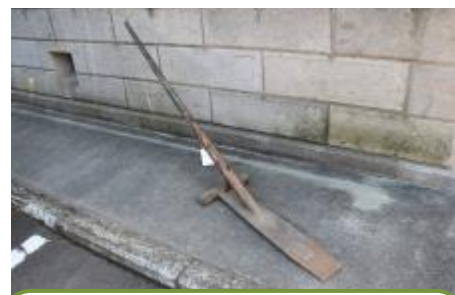
柄鍬：これは人が使うものです。鉄は貴重だったので、風呂ぐわ同様に刃先だけに鉄を用いています。
