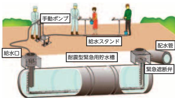
震型緊急用貯水槽を合わせると、2300立方メートルの飲料水が確保でき、これは、人が生存するのに必要とされる1人1日3日で計算すると、約76万人分になります。
