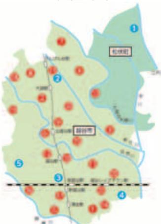
断水等に備え、災害時などに緊急給水ができる耐震型緊急用貯水槽が避難場所など23カ所(うち、越谷市内22カ所)に設置されています。耐震型緊急用貯水槽1基には、100立方メートルの水が蓄えられていて、水道水が循環していません。災害時には手動ポンプと給水スタンドを設置して、給水することができます。23基の耐
