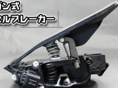
No. 082オルガン式アクセラレーター（車のアクセルとブレーキの踏み間違いによる暴走防…
