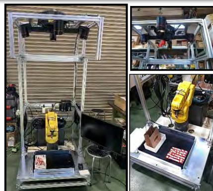
【3Dカメラとロボットのピッキングシステム】
