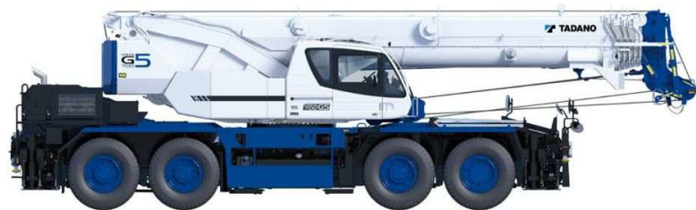
70tラフテレーンクレーン
