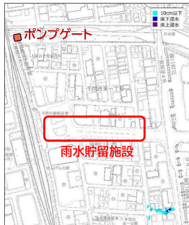
対策施設整備後
