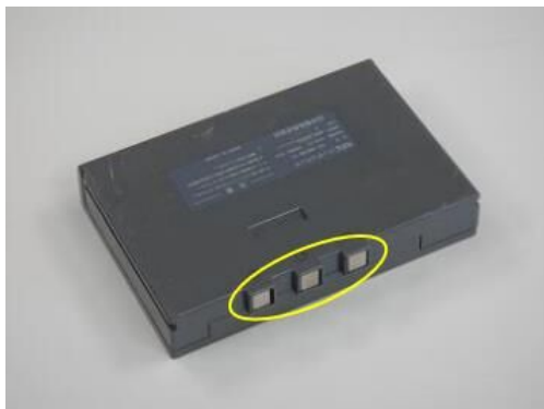
電極端子部露出の例 (出典:JBRC)
