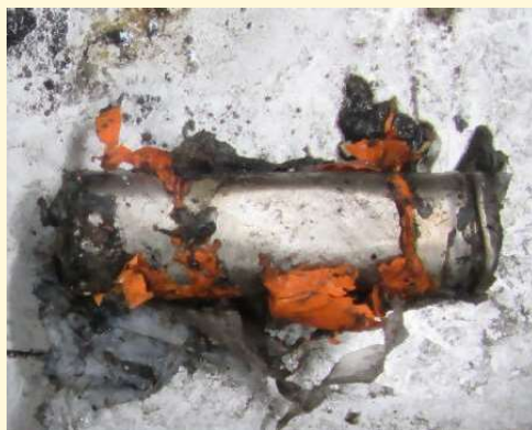
◆発火したリチウムイオン電池
