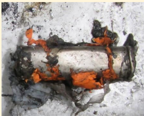
◆発火したリチウムイオン電池
