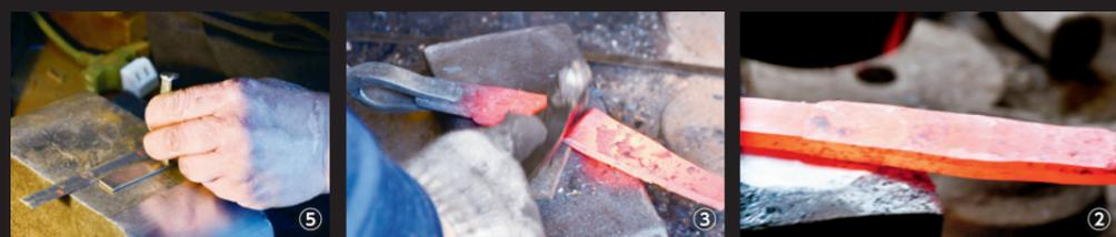
①火床に入れて赤めた地鉄と鋼を叩いて接着します ②接着した素材をさらに叩いて薄く延ばします ③延ばした素材を彫刻刀のサイズに整えます ④藁灰から取り出した素材をまっすぐに打ち直します ⑤「彫刀晟」の刻印を打ちます
