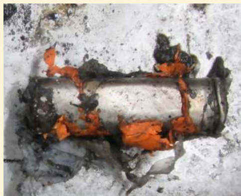
◆発火したリチウムイオン電池
