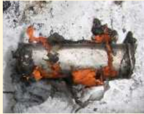
◆発火したリチウムイオン電池
