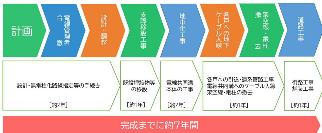
図3-8. 無電柱化事業の流れ [電線共同溝方式による整備の例]
